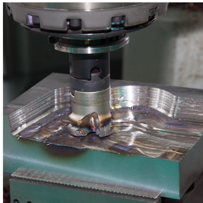
Werkstück mit Folgeschäden nach Schneidplattenbruch
